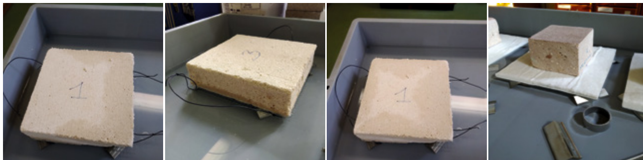
FIGURE 31 Photographies des éprouvettes lors des essais d'absorption capillaire.
