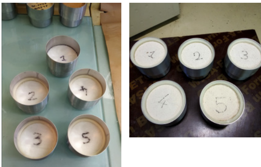
FIGURE 24 Visualisation des coupelles utilisées pour les essais de perméabilité à la vapeur d'eau
