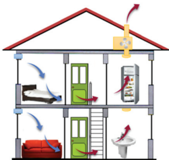
Figure 16 : VMC simple flux par extraction
