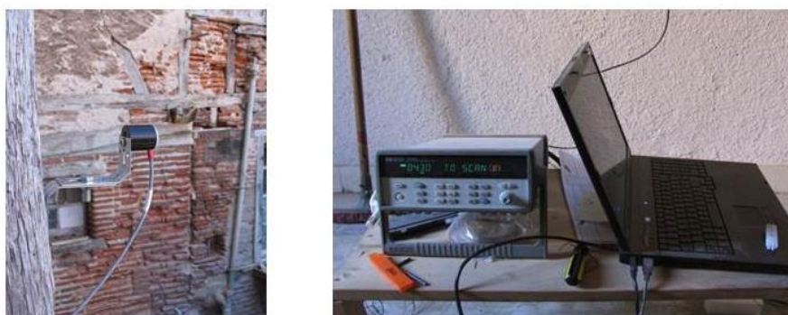
Figure 31: Pyranomètre (gauche) et centrale d'acquisition Agilent (droite)
