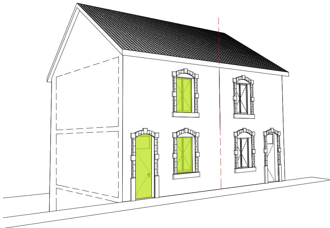
Principe de remplacement des menuiseries extérieures / Dessin de projet après travaux / Document sans échelle
