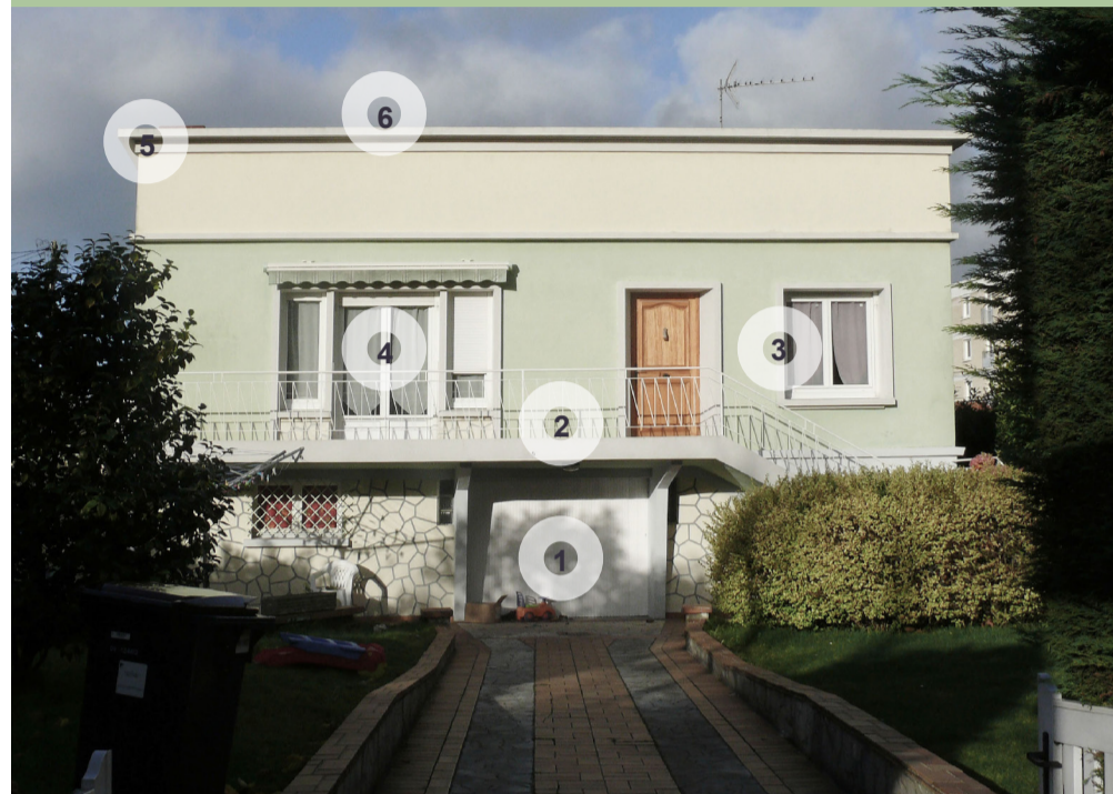
1• garage en rez-de-chaussée, 2• balcon, 3• cadre en saillie de ciment peint, 4• porte-fenêtre du séjour, 5• acrotère traité en corniche, 6• toiture-terrasse ou monopente
