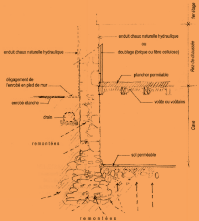
Migration et évacuation de l'eau dans les murs
